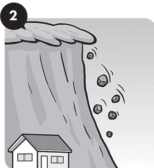
②斜面から小石などが落ちてくる。
